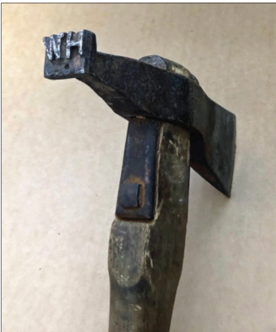
Eine Axt mit dem Meisterzeichen WH (Wolf Hermann), mit welcher ersteigerte Bäume markiert wurden.
